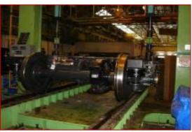
**BOGIE LOAD TEST**
